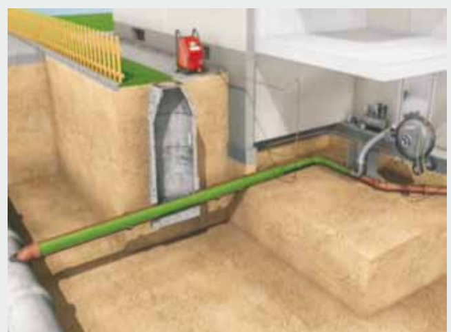
Schlauchlinereinbau im Keller
